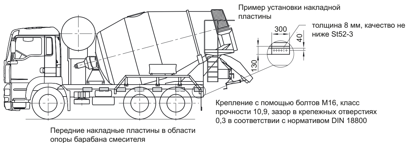
Рис. 62: Автобетоносмеситель TDB-016
